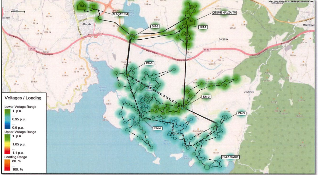
Şekil-2.6.15 Puant yüklenme saatinde gerçekleştirilen yük akış analizi sonuçları (Yüklenme ve gerilim düşümü-YEK'ler devre dışı)
