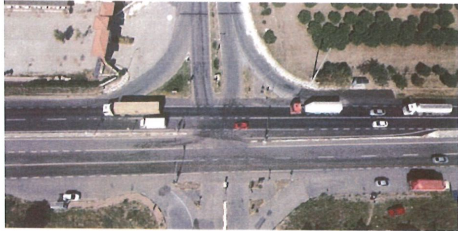
Şekil-2.1.2 Dört Kollu Sola Sığınmalı Kavşaklar
