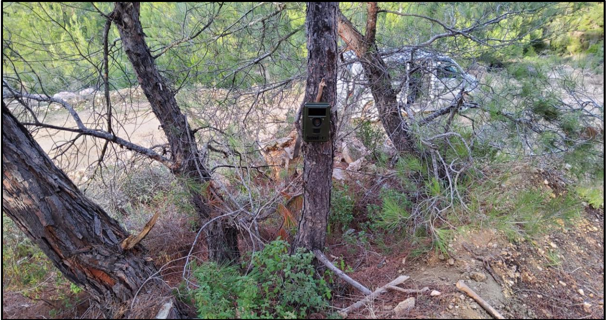
Fotoğraf 58. Ağaç gövdesine sabitlenmiş tuzak kamera (fotokapan) (Fotoğraf: Dr. Pınar Çam İcik)
