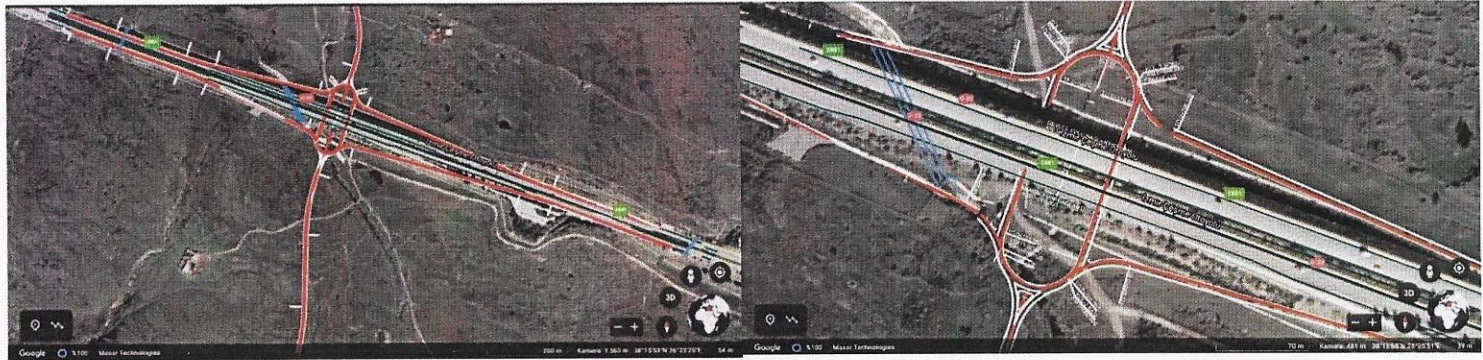
Şekil 155. O-32 otoyolu KTKGB bağlantısı için önerilen Diamond tipi katlı kavşak
